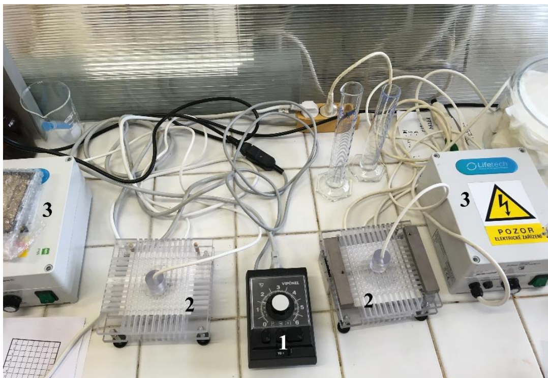
Obrázek 10 Systém pro přípravu PAW dielektrickým bariérovým výbojem s tekutou elektrodou. 1) spínací hodiny; 2) DBD reaktor s Petriho miskou o objemu 75 ml; 3) vysokofrekvenční zdroj napětí
