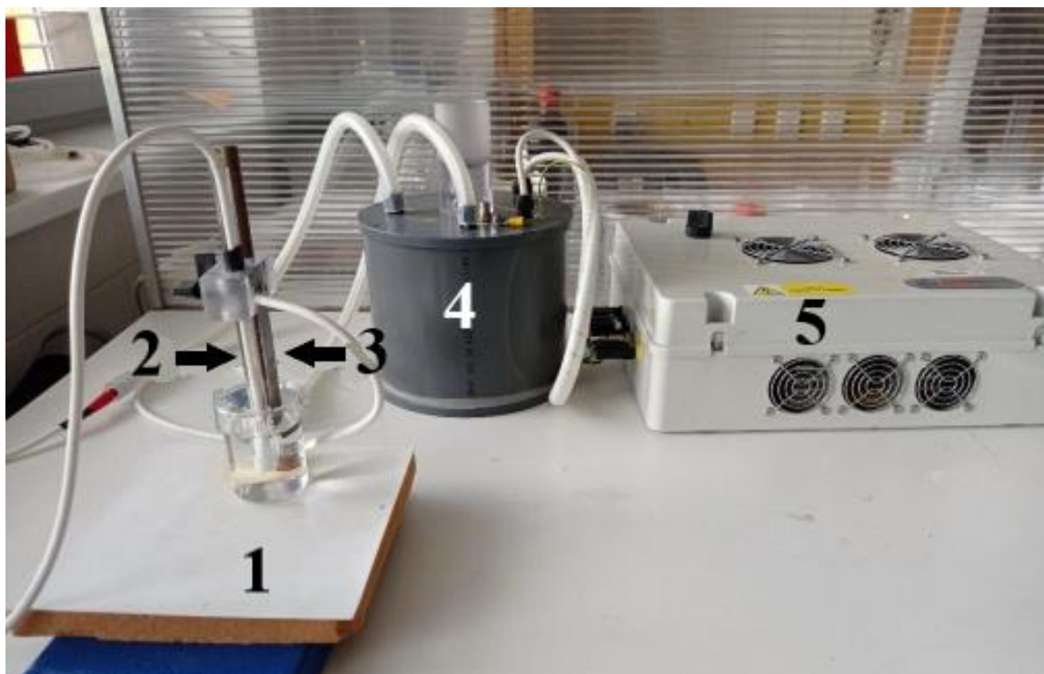
Obrázek 11 Aparatura na přípravu PAW pomocí plazmové trysky ponořené do vody. 1) stojan s plazmovou tryskou ponořenou v kádince s vodou; 2) plazmová tryska; 3) hliníková elektroda; 4) kondenzátor; 5) VF zdroj střídavého napětí
