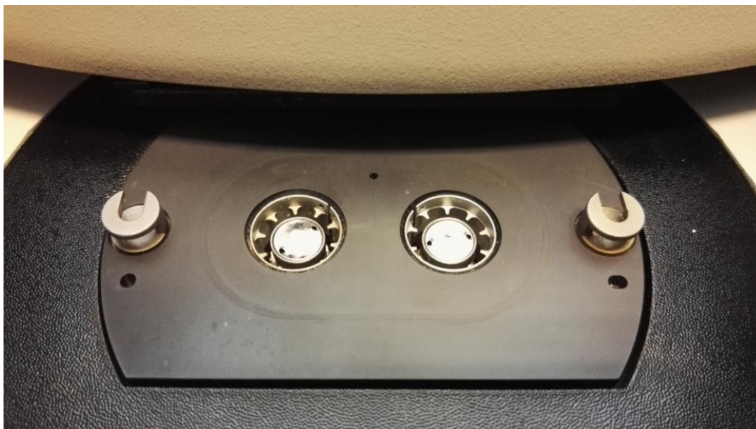
Obr. 34: Snímek DSC měřících cel pro vzorek a referenci přístroje PYRIS 1, Perkin Elmer
