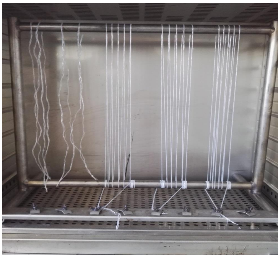
Obr. 35: Snímek uchycení pásků do sušárny
