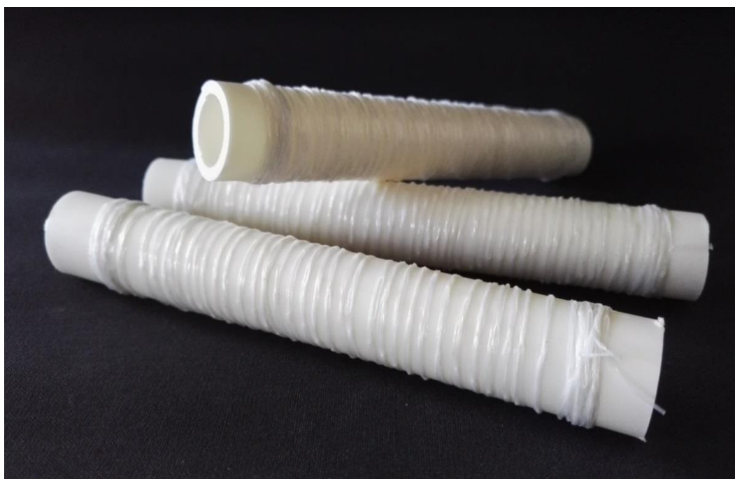
Obr. 36: Snímek uchycení vzorků do xenonové komory Q-sun pod napětím
