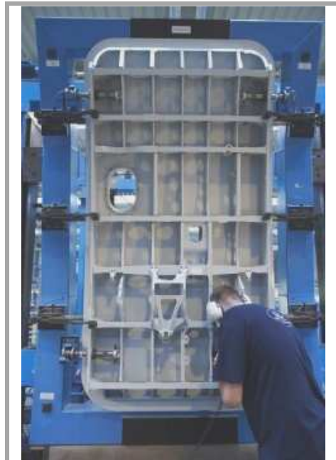
Obr. 27: Nýtovaná montáž dveří [26]
