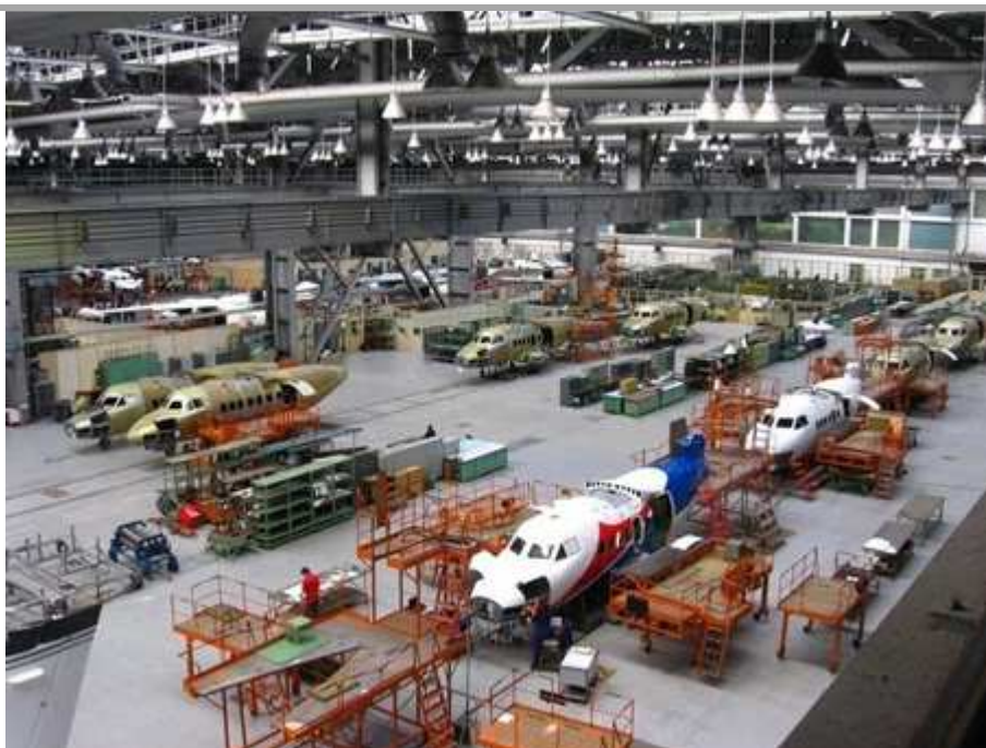
Obr. 23: Současná výroba letounů L-410 v Kunovicích [23]
