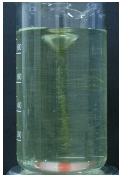
Obr 6.9 Vizualizace vírového pohybu pomocí čajových lístků
