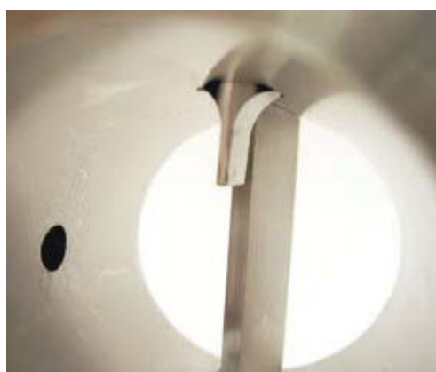
Obr. 5.4 Vnitřní prostor měřicí trubice vírového průtokoměru se snímačem vibrací (v popředí) a vírovým tělesem
