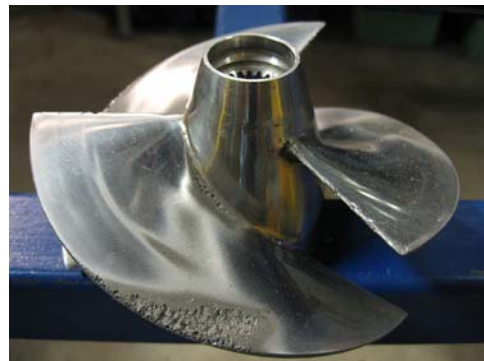
Obr. 2.4 Kavitace v blízkosti materiálu (vlevo) a důsledek působení kavitace (vpravo)
