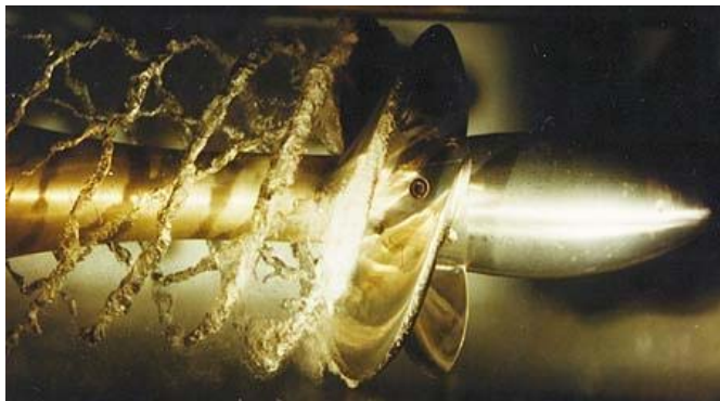
Obr. 2.4 Kavitace v blízkosti materiálu (vlevo) a důsledek působení kavitace (vpravo)
