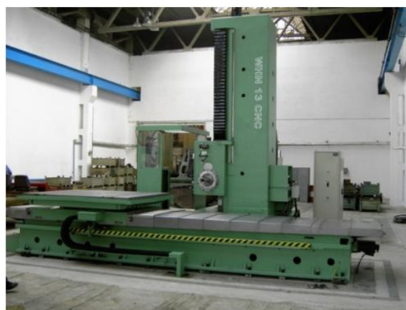
Obr. 10 Horizontální vyvrtávací stroj WHN 13 před modernizací (vlevo) a po modernizaci (vpravo) [Fermat CZ, s.r.o.].
