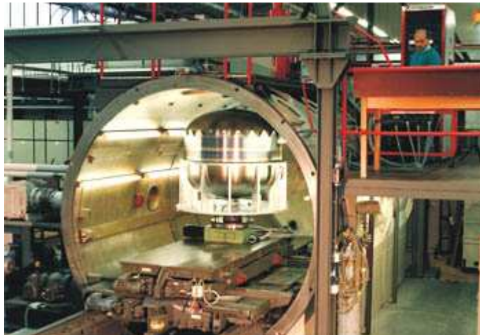
Obr. 3.18. Pracovní komora o objemu 32 m 3 [11]
