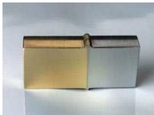
Obr. 3.32 Ukázka svaru u materiálu bronz x ocel ( hloubka 20 mm) [11]
