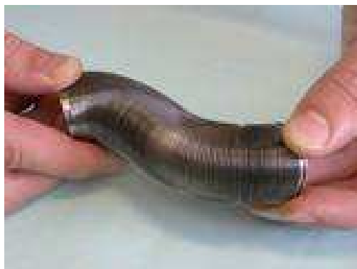
Obr. 3.27 Membránový vlnovec svařený z 400 membrán o tloušťkách 0,05 mm [10]
