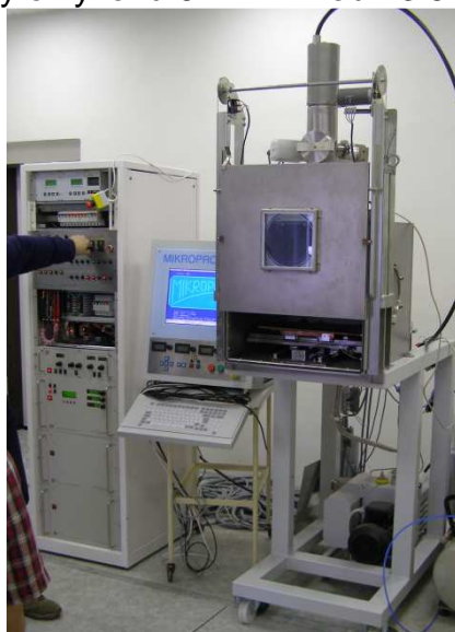
Obr. 3.5 Elektronová svářečka ES3 v ÚJV v Řeži [8]
