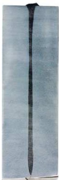
Obr. 3.9 Ukázka úzkého svaru hliníku o hloubce 150mm [8]
