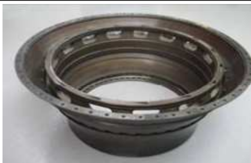
Obr. 3.30 Oprava vnitřní trysky motoru [11]
