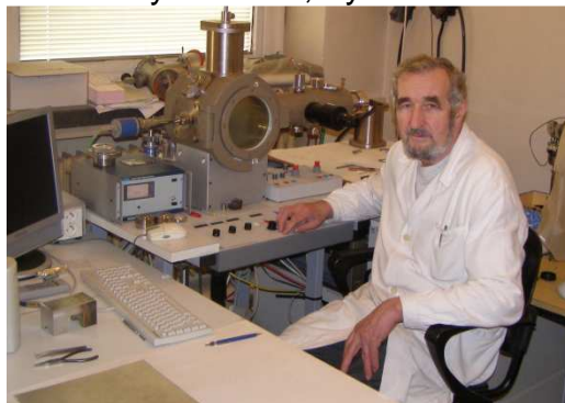
Obr. 3.4 Elektronová svářečka pro svařování malých rotačních součástí [8]
