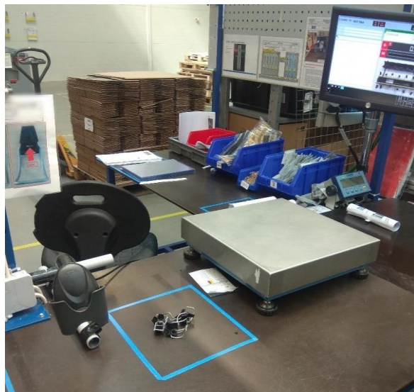
Obr. 39: Umístění skeneru do stabilní polohy a sdílení kontrolní váhy mezi pozicemi příbalů a kontrolního vážení [70]
