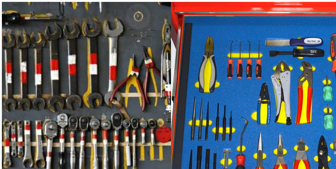
Obr. 11 Příklad Shadow Boardu a nástrojové pěny [50]
