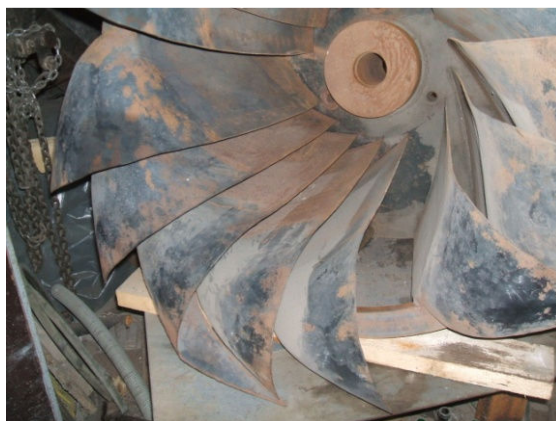
Obr. 27 Oběžné kol z vnitřní strany (náboj, otvory vyrovnávající tlak)
