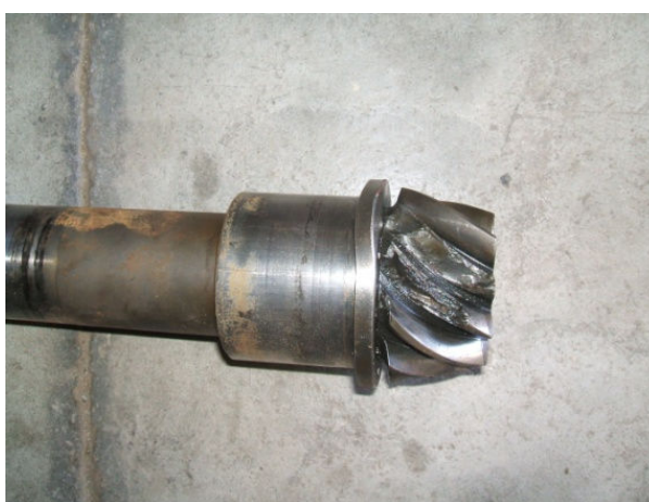
Obr. 14 Poškozené ozubení kuželového pastorku
