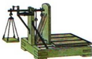
Obrázek 9: Mechanismus decimální váhy (převzato z [10]).
