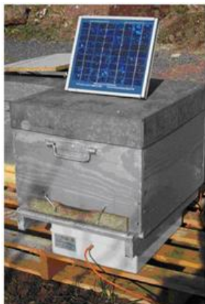
Obrázek 3: Váha BeeWise měřící hmotnost, napájena solárním článkem (převzato z [4]).
