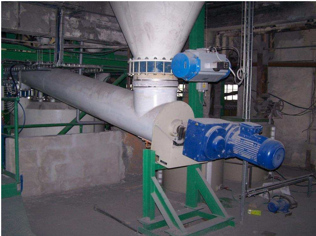
Obr. 5.3: Klapka pod vahou VPS spolu s dávkovacím šnekem
