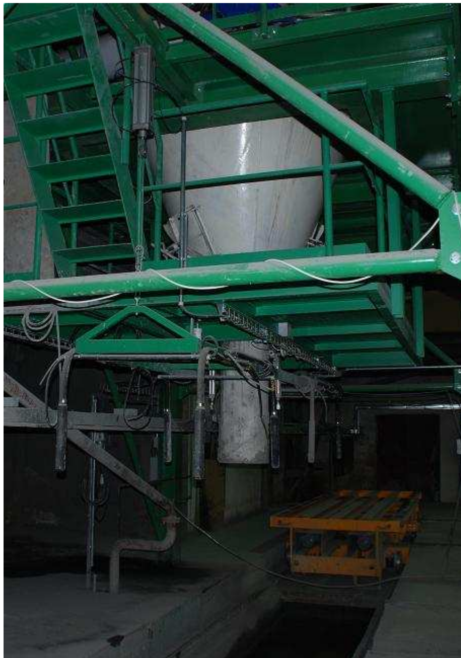
Obr. 5.5: Spodní část míchačky s teleskopickou tyčí a ponornými vibrátory
