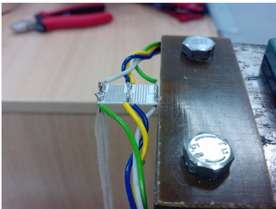
Obr. 4-9 Čidlo pro TDS tepelné radiace upevněné na chladiči
