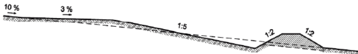
Obr. 3.3.3 Vzorový příčný řez hrázkou [2]
