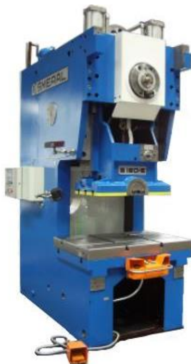
Obr. 50 Výstředníkový lis S 160 E [43].
