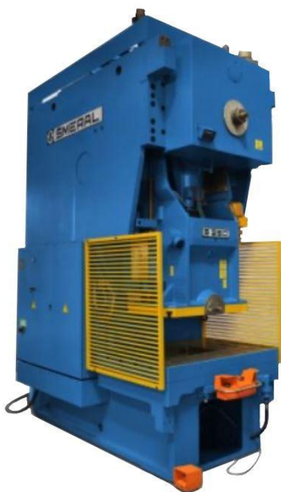
Obr. 31 Mechanický výstředníkový lis [40].
