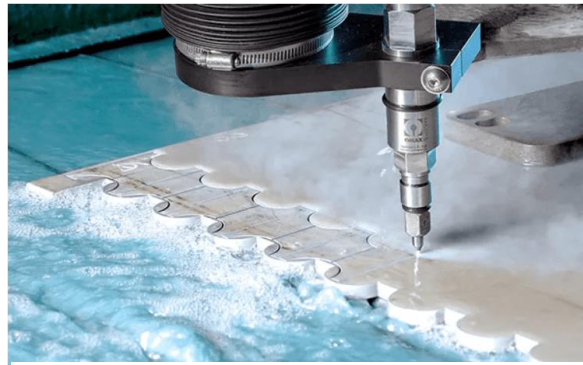
Obr. 7 Řezání vodním paprskem [23].
