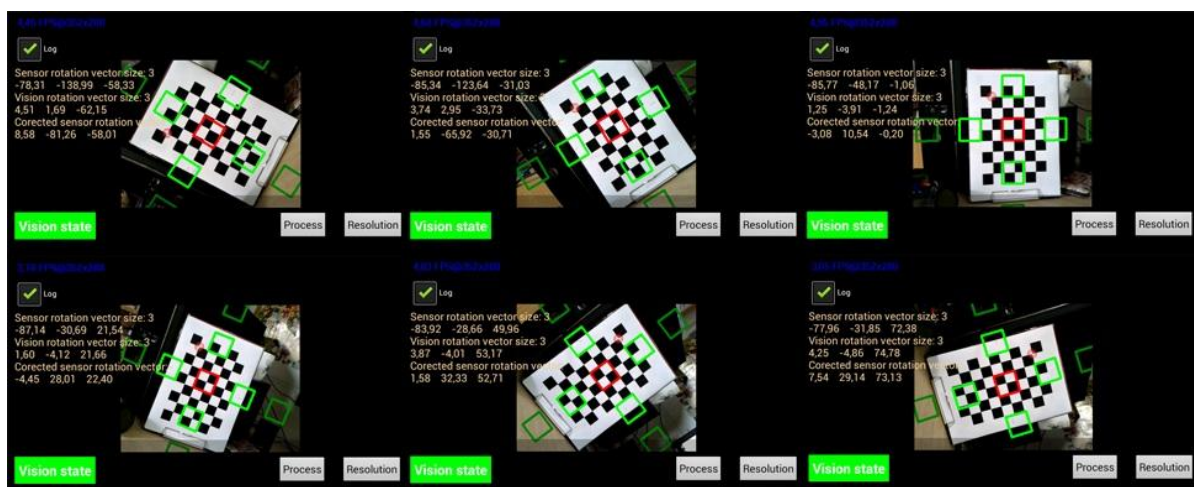
5.12 Vizualizace objektu s rotačním vektorem částečně složeným z informací získaných ze senzorů (rotace kolem osy z)
