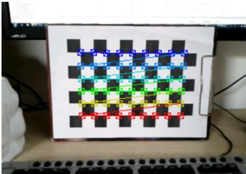
3.11 Vizualizace nalezených rohových bodů při lokalizaci šachovnice
