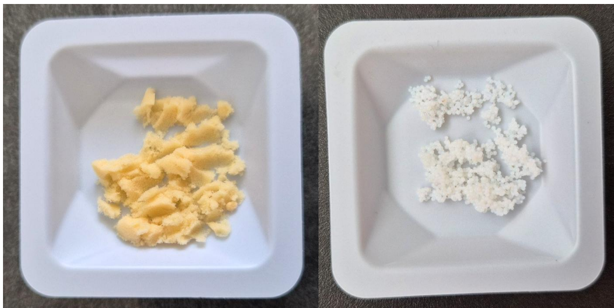
Obrázek 7: Sorbent na principu iontové výměny Dowex® 50X 8 (vlevo) a sorbent na principu fyzikální adsorpce Amberlite® XAD16N (vpravo).
