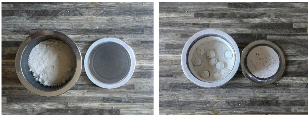
Obrázek č. 20: Sádrovec s budičem před mletím (vlevo); na sucho pomletý a zhomogenizovaný sádrovec s budičem (vpravo)
