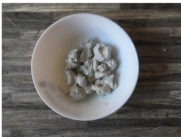
Obrázek č. 21: Vytvořené sbalky ze směsi sádrovce, budiče a vody
