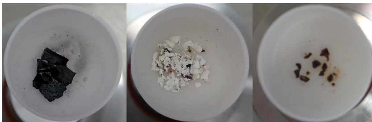
Obr. 30: Výsledné produkty po experimentálním měření. Zleva: dusíková atmosféra, vzdušná atmosféra, atmosféra se změnou
