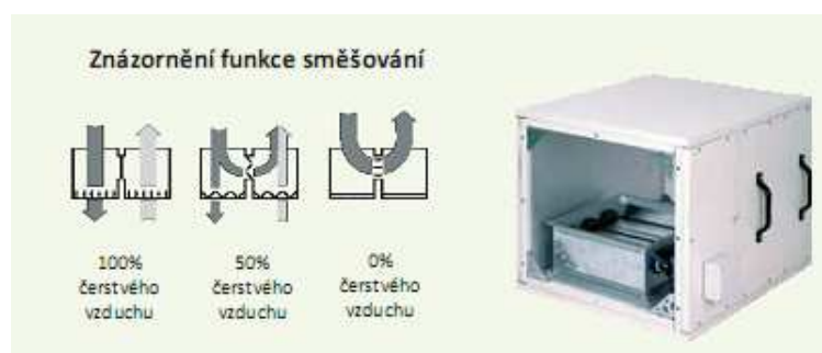
Obr. 11 Znázornění funkce směšování a směšovací díl společnosti Remak [24]
