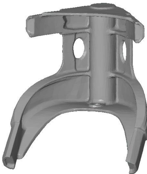
Obr. 13 – Opravená a zjednodušená polygonální síť naskenované hlavy rámu
