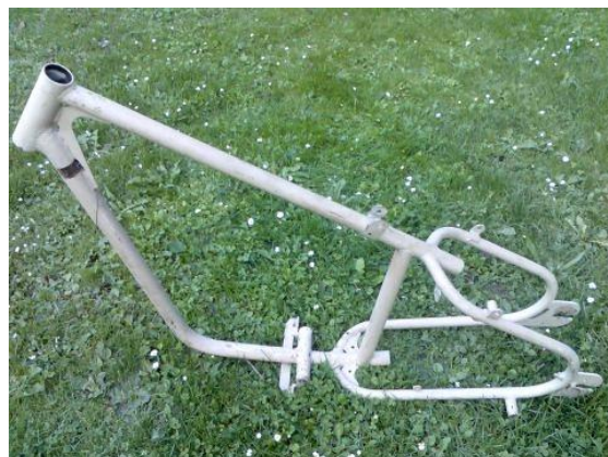
Obr. 5 – Uzavřený jednoduchý rám [9]
