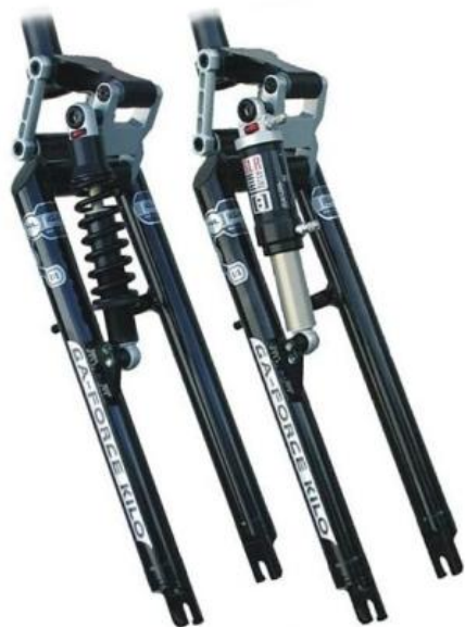
Obr. 2 - Paralelogramové odpružení jízdního kola [6]
