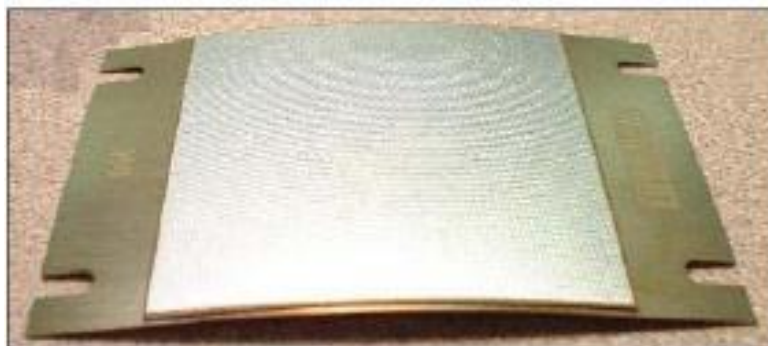
Obrázek 5-7 Lepení keramické vrstvy pomocí technologie THUNDER ® [15]
