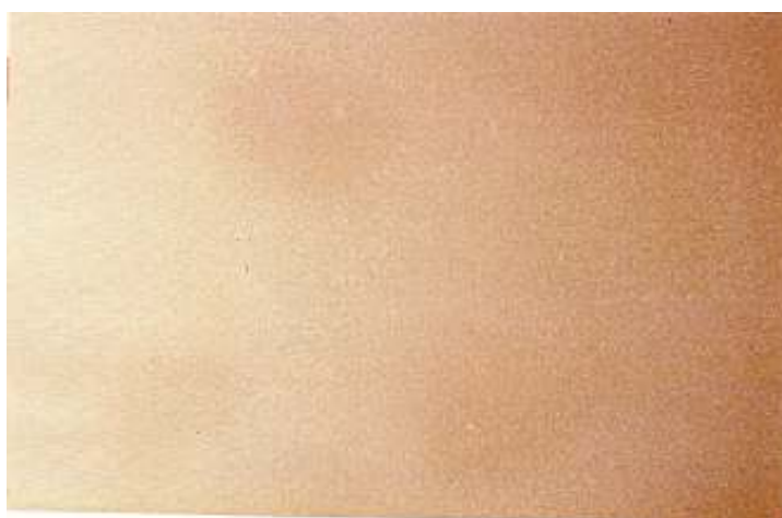
Obr. 18: Oblaky pri striekaní metalickým lakom
