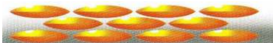
Obr. 16: Rovnomerná štruktúra metalického zrna čočkovitého tvaru
