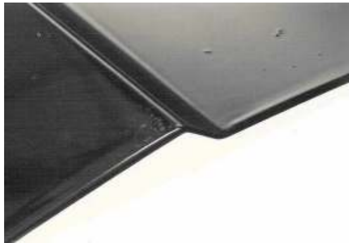
Obr. 19: Špina a prach pod nalakovanou vrstvou
