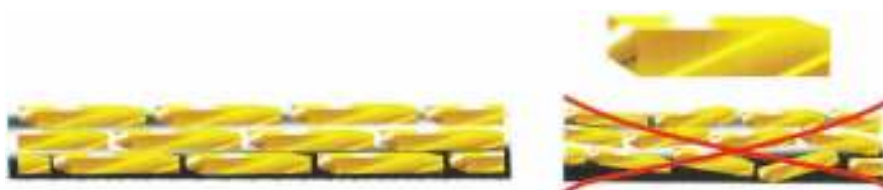
Obr. 15: Ukážka správneho a nesprávneho usporiadania metalických zrn v štruktúre
