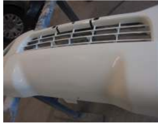
Obr. 6: Materiál nastriekaný základnou farbou
