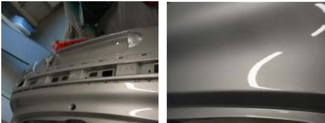
Obr. 8: Ukážka správne nastriekaného a vysušeného materiálu (metalický lak)
