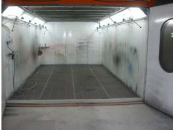
Obr. 7: Príklad striekacej a zároveň aj sušiacej lakovacej kabíny
