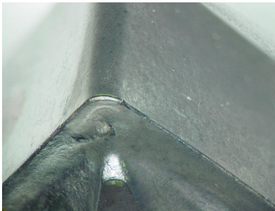
Obr. 5.18 VBD WNMG 3-1-NF po experimentu.
