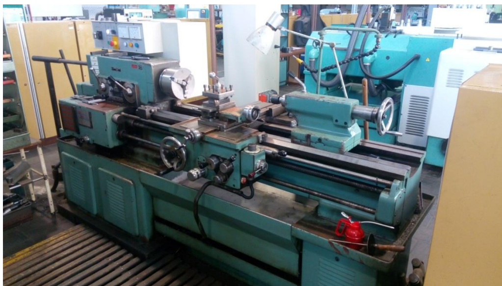
Obr. 5.3 Použitý obráběcí stroj TOS SV 18 RD.
