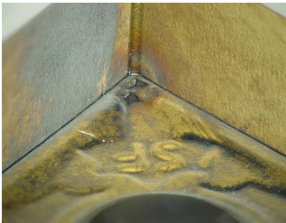
Obr. 5.20 VBD WNMG 3-0-SF po experimentu.
