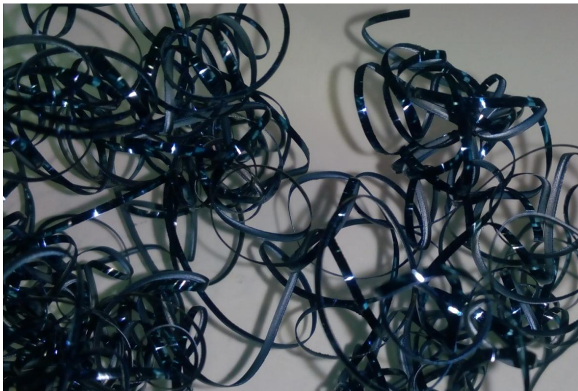
Obr. 5.10 Vznikající tříška při testování VBD typu WNMG 3-2-VL.
