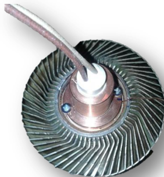
Obr. 29: Topná patrona jako náhrada za tepelnou část elektronky
