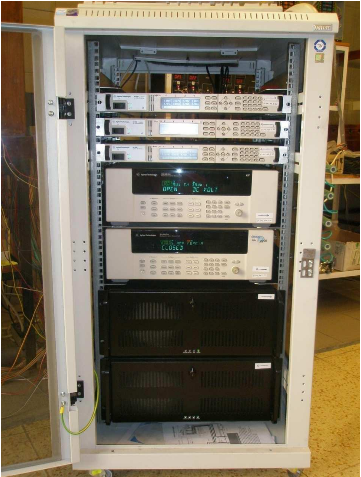
Obr. 3.5 Kompletní sestavení měřicího pracoviště (nahore 3 sady zdrojů Agilent N6700B, uprostřed 2 multifunkční digitální ústředny Agilent 34980A, dole 2x PC)
