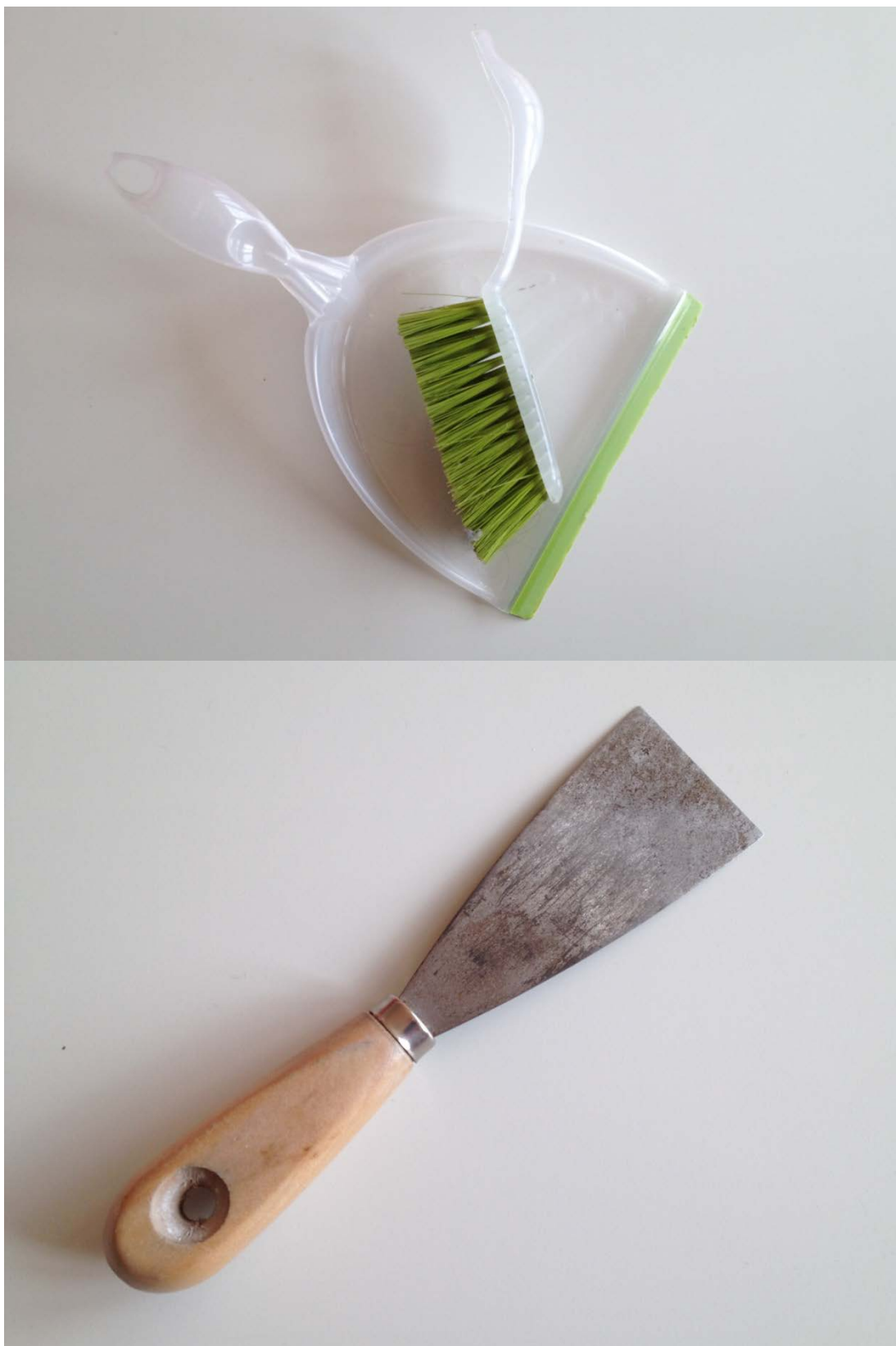
Obrázek č. 16: nástroje použité k odběru prachu (nahore) a půdy (dole). (autor: R. Dvořák)
