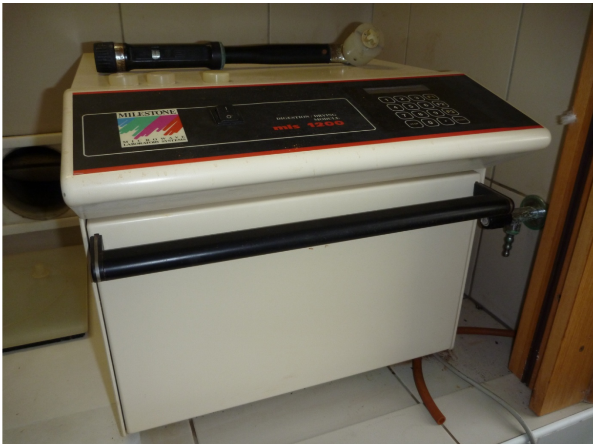
Obrázek č. 8: mikrovlnný extraktor Milestone mls 1200 (autor: Rostislav Dvořák)
