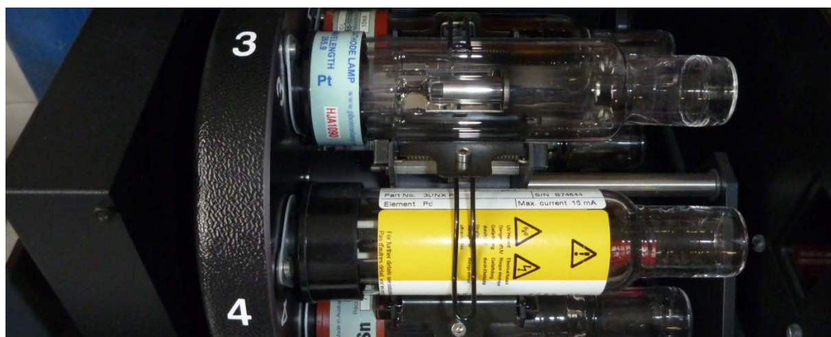
Obrázek č. 12: ETA-AAS platinová lampa s dutou katodou (autor: Rostislav Dvořák)
