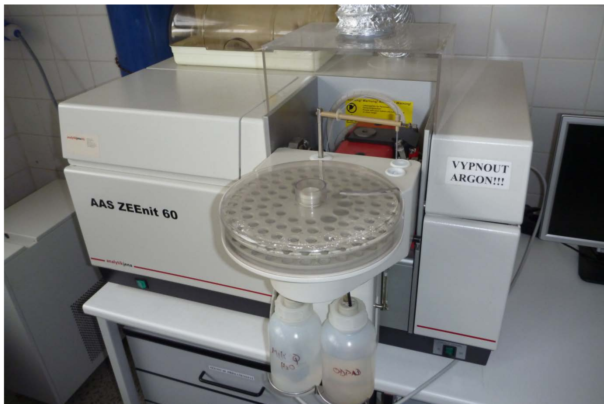
Obrázek č. 11: ETA-AAS ZEE nit 60 od firmy AnalytikJena AG (autor: Rostislav Dvořák)
