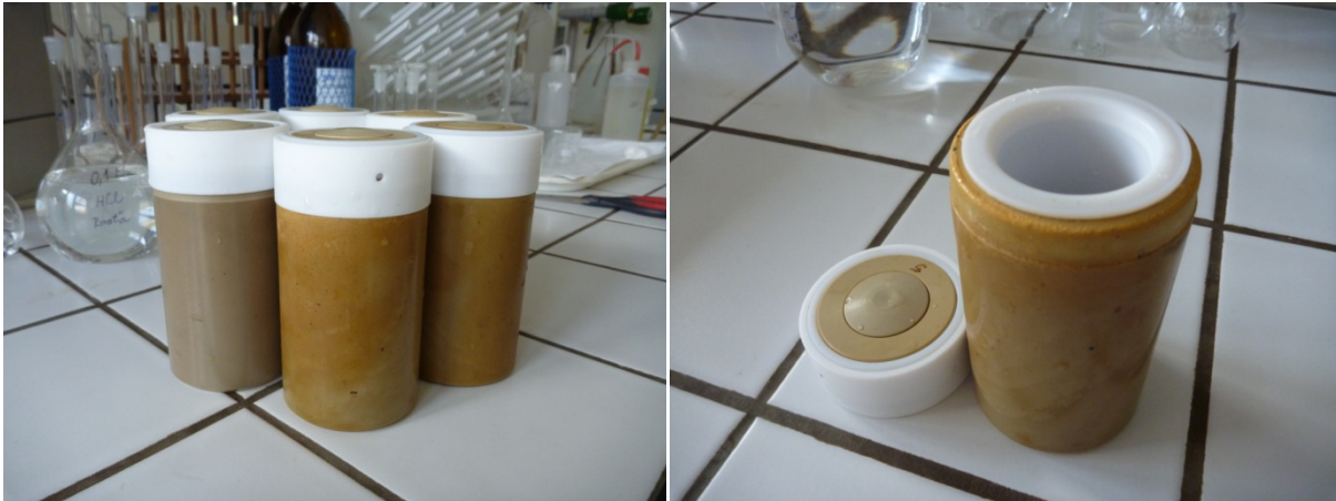
Obrázek č. 7: Patrony pro Mikrovlnný extraktor Milestone (autor: Rostislav Dvořák)
