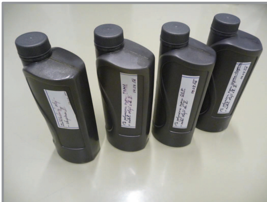
Obr. 20 Jednotlivé mazivá obsiahnuté v experimente: Základový olej skupiny II., PAMA 1%, OCP 1%, styren-isopren 1% (zľava)
