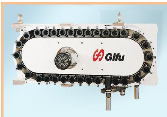
Obr. 31 Řetězový zásobník od firmy Gifu ENTERPRISE CO., LTD. [10]
