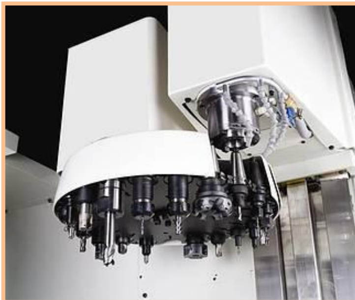
Obr. 7 Přímá výměna s lineárním vedením a 21-ti místným zásobníkem od firmy Fadal [12]
