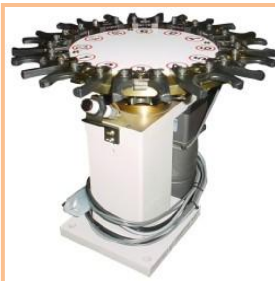
Obr. 11 Deštníkový zásobník od firmy AENY INTERNATIONAL INC. [6]
