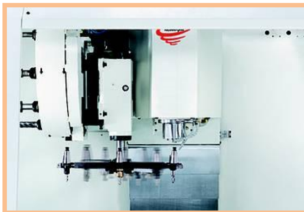
Obr. 19 Nepřímá výměna od firmy Fadal [12]
