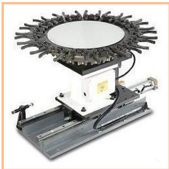
Obr. 10 Deštníkový zásobník od firmy AENY INTERNATIONAL INC. [6]
