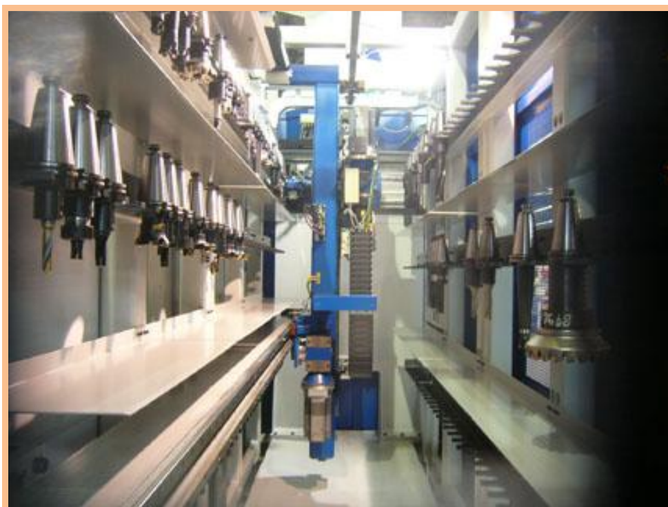
Obr. 40 Kombinovaný regálový zásobník od firmy Gruppo Riello Sistemi [16]
