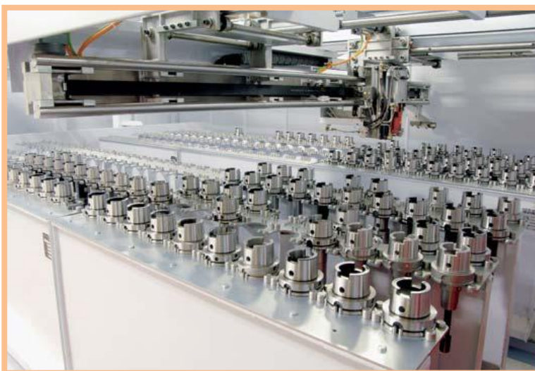
Obr. 37 Zásobník u frézovacího centra nbh 350 od firmy Hüller Hille [13]
