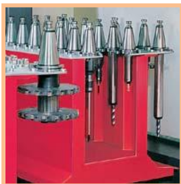
Obr. 35 Vodorovný zásobník od firmy Hüller Hille [13]
