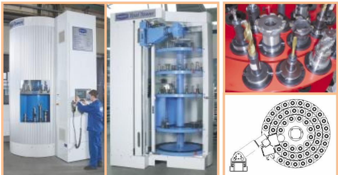
Obr. 28 Regálový diskový zásobník od firmy Demmeler Maschinenbau GmbH Co. KG [8]
