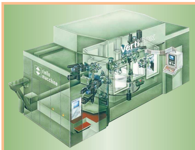
Obr. 5 Frézovací centrum Vertiflex od firmy Gruppo Riello Sistemi [16]
