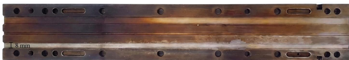
Obr. 21: Vnitřní geometrie pultruzní formy
