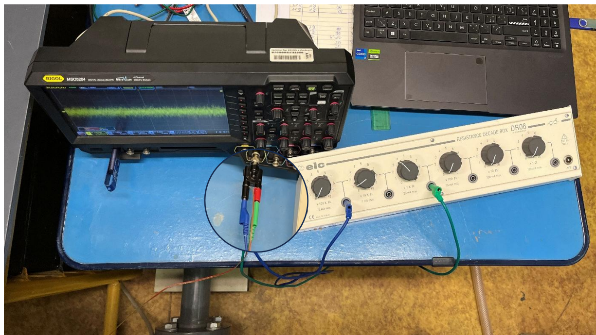
Obrázok 4-8 – Spôsob spojenia patchu s osciloskopom a odporovou dekadou, zdroj: autor
