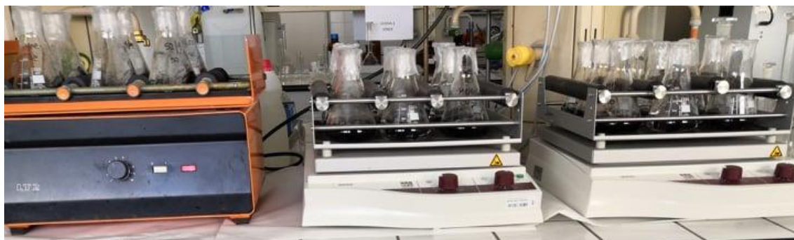
Obrázek 6: Vzorky sorbentů na třepačkách.
