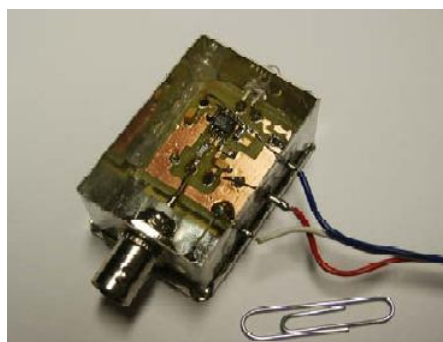
Obr. 2.34 Transimpedanční zesilovač s fotodiodou ve stínícím krytu
