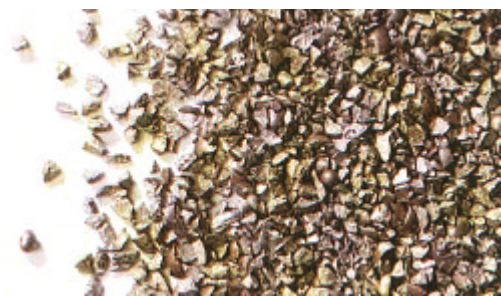
Obr. 3 Ostrohranné abrazivní částice [1]
