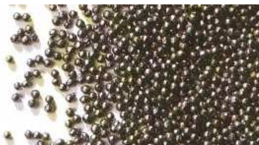
Obr. 2 Kulaté abrazivní částice [1]
