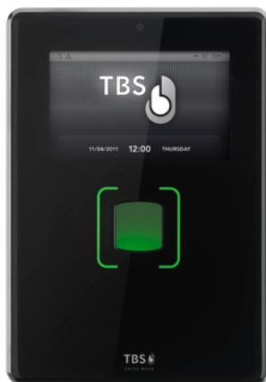
Obrázek 2.1: 3D terminál firmy TBS se senzorem Surround Imager.
