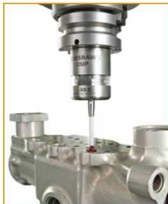
Obr. 4 kontrola rozměrů obrobku [1]
