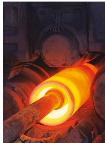
Obr. 22 Postup valcovania Mannesmann [22], [63]
