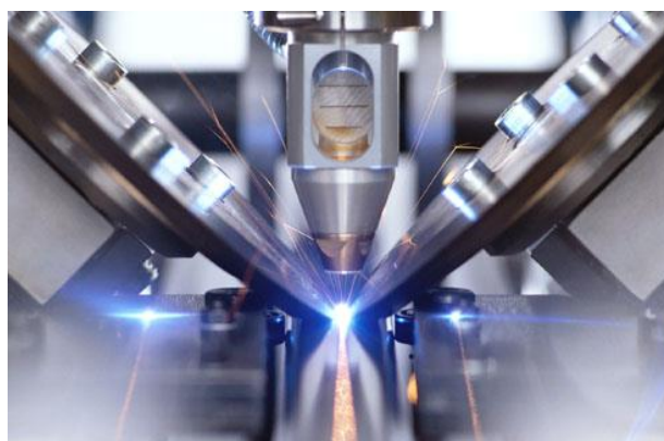
Obr. 44 Kontinuálne zváranie trubiek laserom [57]
