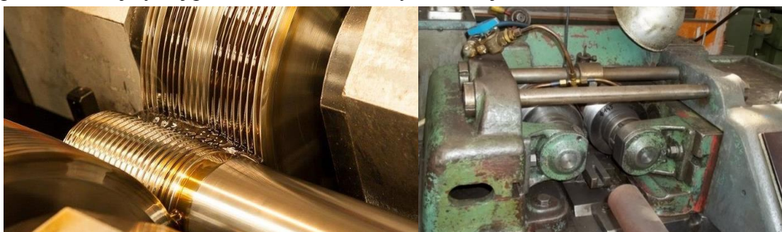
Obr. 19 Valcovanie závitových tyčí [61]
