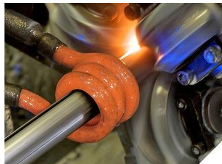
Obr. 42 Indukčné zváranie trubiek [55]
