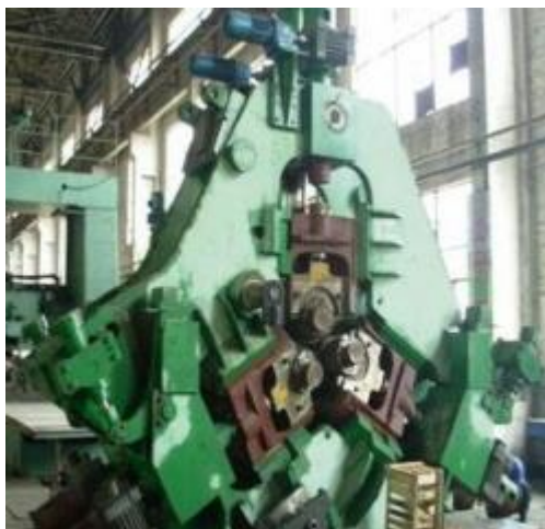
Obr. 26 Stroj využívajúci technológiu Assel [17]
