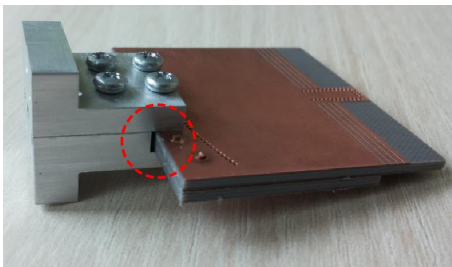
Obrázek 59: Chyba v přechodu WR-15 na SIW
