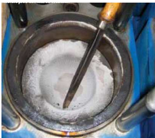
Obr. 6 Usazování \text{SiO}_2 na povrchu pístu ve spalovacích prostorech motoru v podobě pevné krusty [15]
