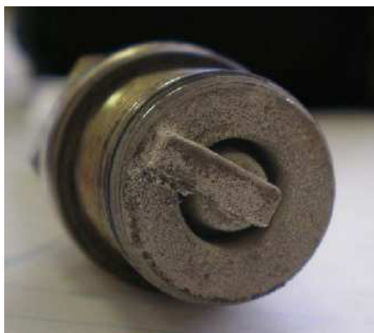
Obr. 5 Oxid křemičitý usazený na zapalovací svíče [15]
