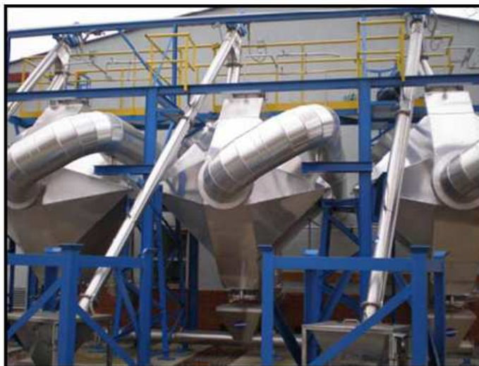
Obr. 8 Adsorpční jednotky na ÚČOV Praha – Bubeneč [15]
