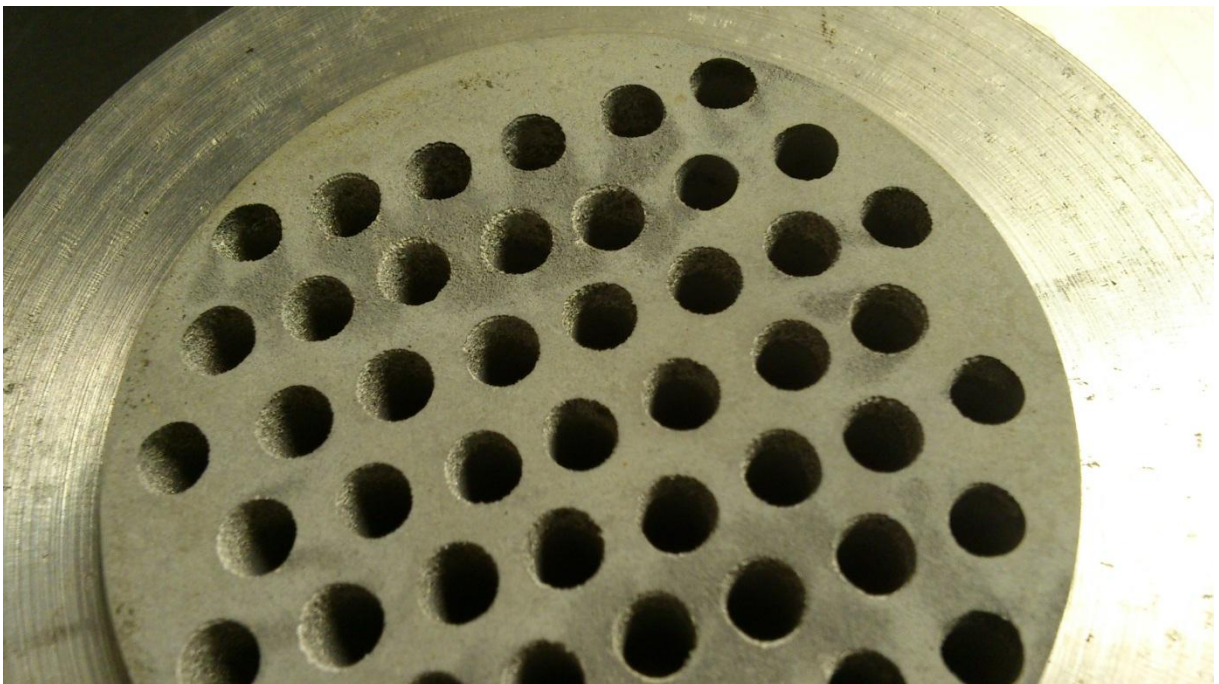
Obrázek 27: Vzorek č. 2 ovlivněný kavitací, zdroj: Ing. Martin Hudec
