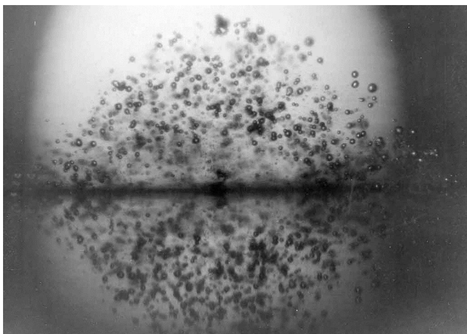
Obrázek 9: Oblak kavitačních bublin [4]
