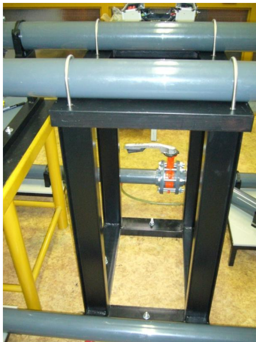
Obrázek 12: Podstavec pro vyztužení tratě, zdroj: autor
