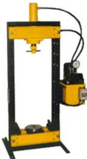
Obr. 17) Dílenský hydraulický lis řady CDMR od firmy TOS RAKOVNÍK [16]
