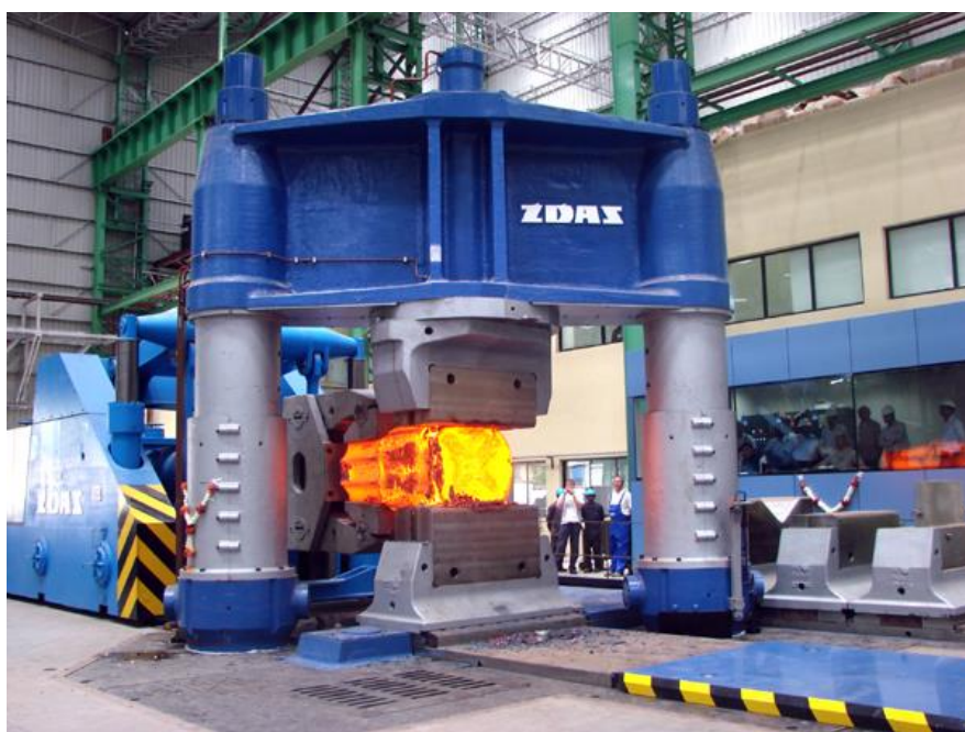
Obr. 11) Hydraulický dolůtažný kovací lis řady CKW dvousloupové konstrukce od firmy ŽDAS [13]
