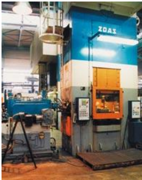
Obr. 12) Klikový lis jednobodový řady LKJA 250 od firmy ŽDAS [13]
