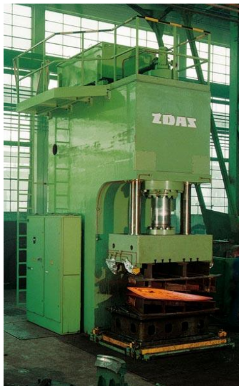
Obr. 9) Otevřený rám univerzálního hydraulického lisu CTC od firmy ŽĎAS [13]
