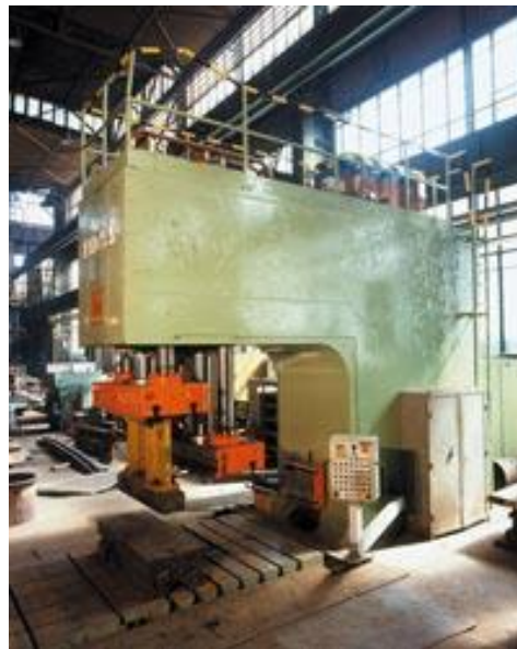
Obr. 14) Univerzální hydraulický lis CTC od firmy ŽĐAS [13]
