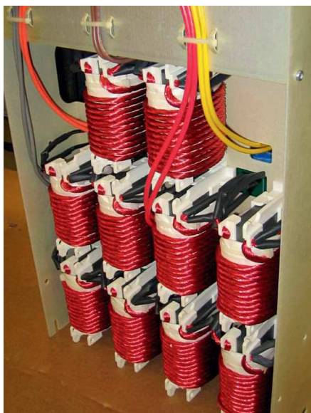
Obr. 11 : Tlumivky poloviny úplného výkonového řetězce beztransformátorové technologie
