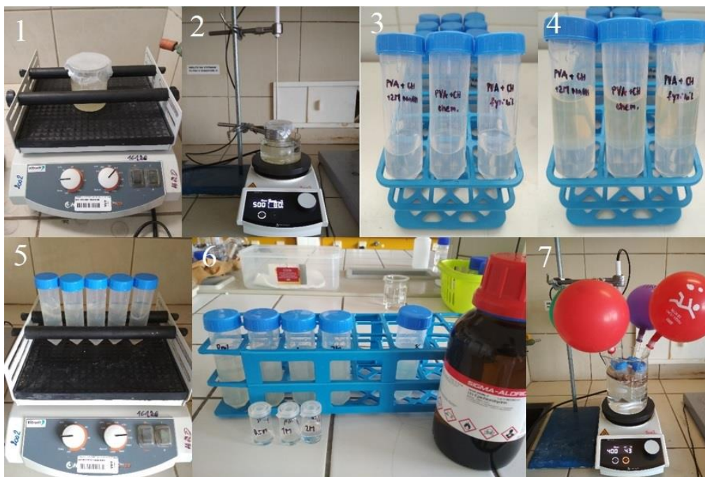
Obrázek 21: Pracovní postup u chemicky síťovaných hydrogelů
