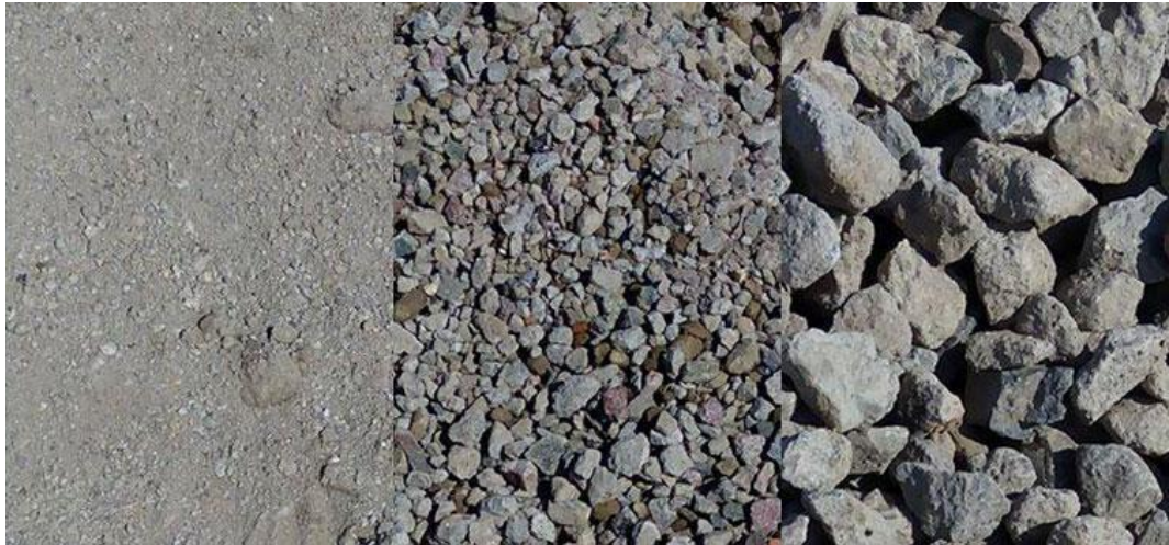
Obr. 8 Betonový recyklát jemné, střední a hrubé frakce
