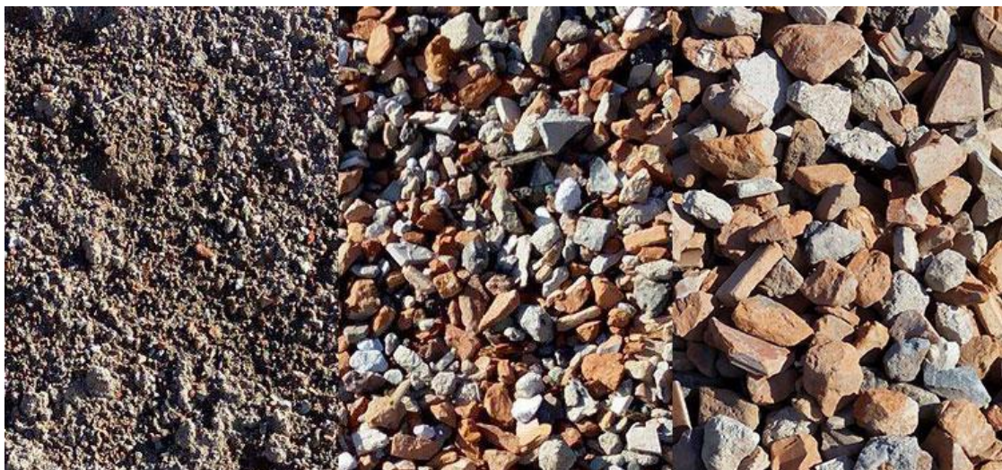
Obr. 7 Směsný recyklát jemné, střední a hrubé frakce
