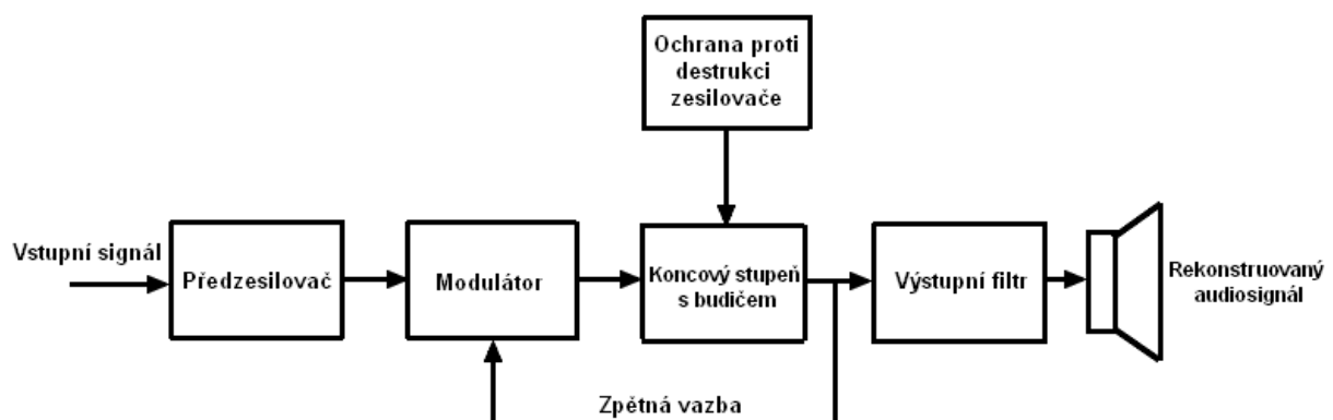
Obr. 2.1: Princip zesilovače spínané třídy (převzato a upraveno z [2])
