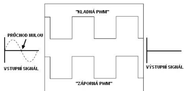
Obr. 2.3: Třída I, průchod nulou (převzato a upraveno z [8])
