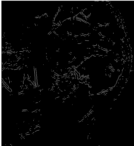
Obr. 3.18: Hrany detekované metodou detekce hran v Laplaceově operátoru z gaussovsky rozostřeného obrazu s optimálně nastavenou rozhodovací úrovní i směrodatnou odchylkou.
