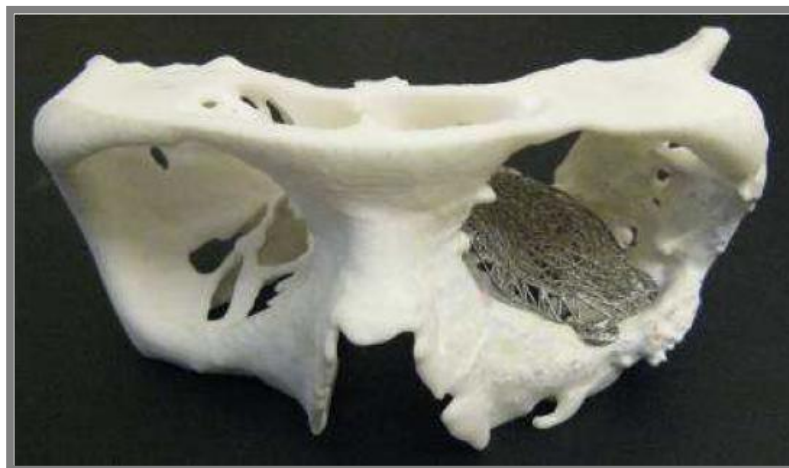
Obr. 1.10 Předoperační model části lebky vyrobený metodou SLS a titanový implantát vyrobený metodou DMLS. [24]
