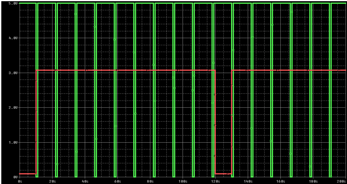
Obr. 20: Prodloužení signálu PIR ( simulace )
