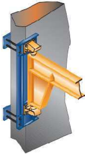
Obr. 3.5 Upevnění pomocí nástěnných konzol a průchozích kotev [7]
