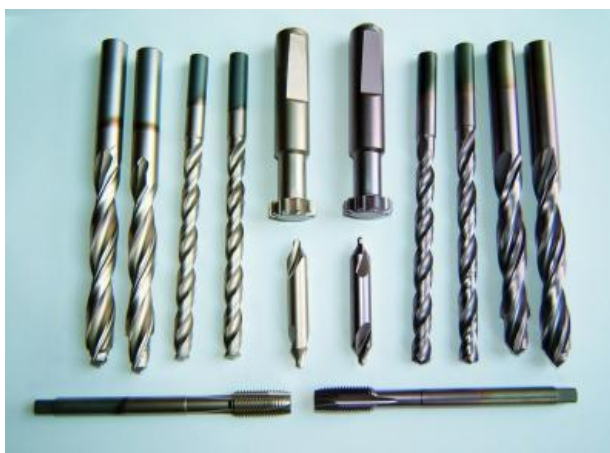
Obr. 3.2 Povlakované nástroje metodou PACVD [21].
