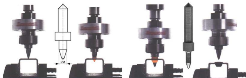
Obr. 1.12 Termální vrtání díry [2].
