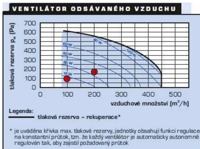
Obr. 7.5: Výkonové parametry ventilátoru odsávaného vzduchu ( V_m=220 m^3 \cdot hod^{-1} , \Delta p_c=66,75 Pa ) [46].
