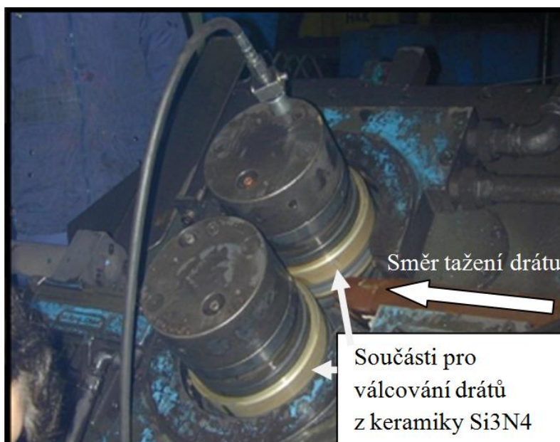
Obr. 4 Fotografie válcovací stolice osazené kroužky z \text{Si}_3\text{N}_4 (RoLiCer 2013)
